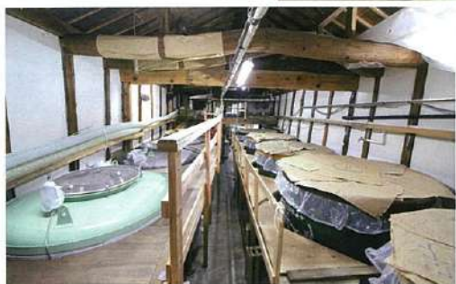
▲仕込み蔵のもろみタンクは5000ℓを中心に23本。サーマルタンクは高精白の大吟醸・純米大吟醸クラスのものや本生、生貯蔵を0℃～3℃で管理する。酵母は新潟県醸造試験場G9、S9酵母、協会601号、1801号などを使い分ける。G9酵母は酸が少なく発酵力旺盛、香りのバランスが良い。
