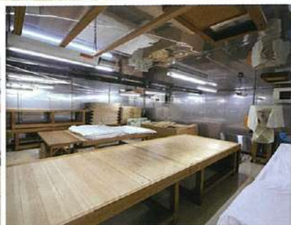
▲仕込み蔵の麹室は新洋技研工業(株)のステンレスパネル式廻室。低精白純米酒については中立工業(株)の天幕式自動製麹装置を使用し、それ以外は箱廻だ。5kgと12kgの箱があり、5kg盛りの箱廻を使う比率が高い。
