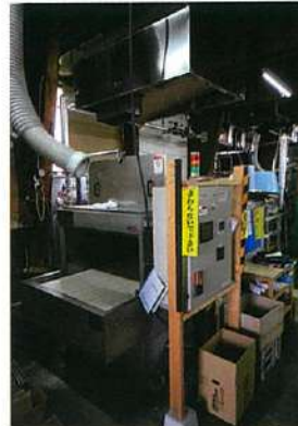
▲学校時代の理科室と理科準備室を改造した醸造設備。メインの仕込み蔵と異なり、学校蔵では洗米についてもMJP式洗米機を使用。酒母も速醸のみならず1昨年から2年間山麴、今年からは生麹に挑戦する。
