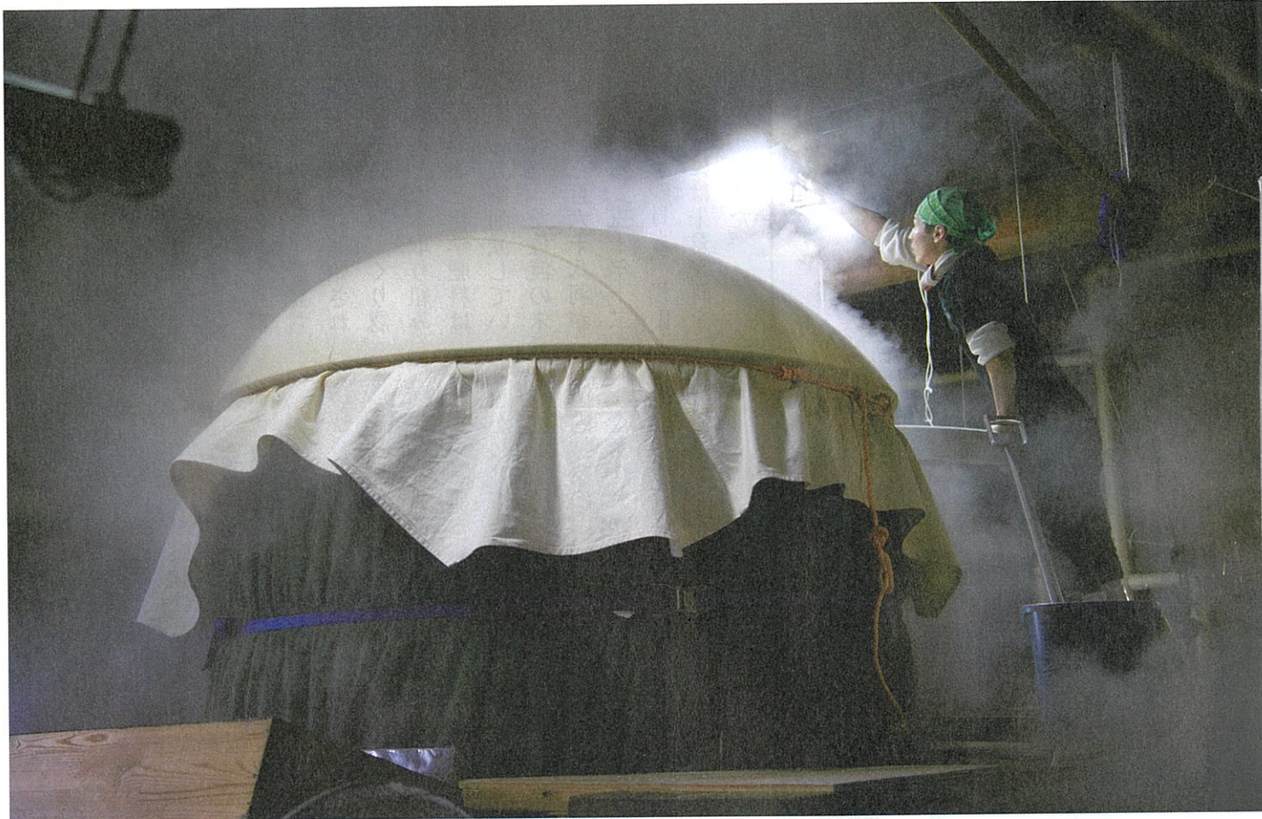
大きな釜に甑をセットし、酒米を蒸しあげる。布が大きく膨れあがった姿は圧巻
